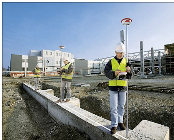
Figura 4 - Ilustração do receptor e antena GPS com o operador em campo
